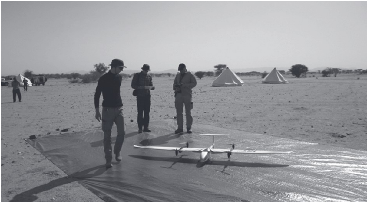
Abb. 3: Schwenkflügler-Quadrocopter der Firma Thamm Geotechnic im Einsatz im Wadi Abu Dom
